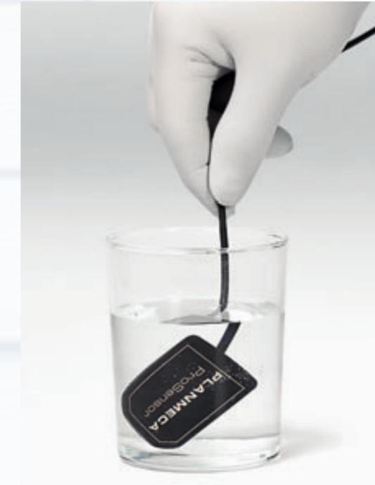
Le système Planmeca ProSensor a été conçu, d'abord et avant tout, en pensant à sa longévité. Le câble du capteur est le résultat d'un effort intense de conception, de technologie et de test. Le câble est renforcé par du Kevlar et ne contient que deux fils. Cette construction s'est avérée particulièrement durable lors d'un test minutieux consistant à plier le câble plus de 100.000 fois. La conception intelligente du boîtier, avec des bords arrondis et une zone d'imagerie active étendue optimise
